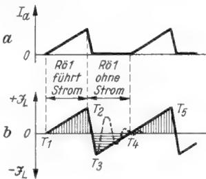
Bild 138. Anodenstrom und Strom in den Zeilenablenkspulen
