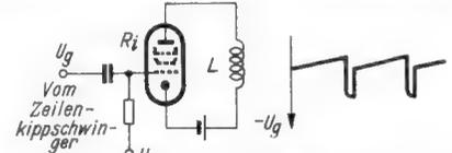
Bild 134. Prinzip der Zeilenendstufe
