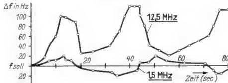
Bild 3. Frequenzunruhe durch Heizfadenbewegung im Kathodenröhrchen (absichtlich fehlerhaft ausgeführte Röhre)
