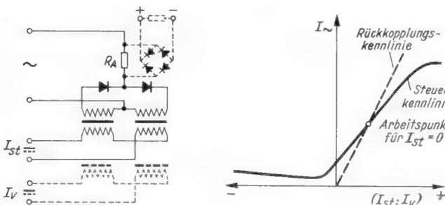
**Bild 6.** Magnetischer Verstärker in Parallelschaltung mit Selbstsättigung. Der angezeigte zweite Gleichstromkreis dient zur Einstellung des Arbeitsbereiches durch Parallelverschiebung der Steuerkennlinie. An die Stelle des Wechselstromverbrauchers kann ein Gleichrichter zur Speisung eines Gleichstromverbrauchers treten
