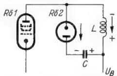
Bild 136. Prinzip der Schalterdiode
