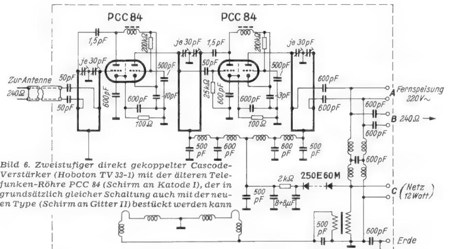
Bild 6. Zweistufiger direkt gekoppelter Cascode-Verstärker (Hoboton TV 33-1) mit der älteren Telefunken-Röhre PCC 84 (Schirm an Katode I), der in grundsätzlich gleicher Schaltung auch mit der neuen Type (Schirm an Gitter II) bestückt werden kann
