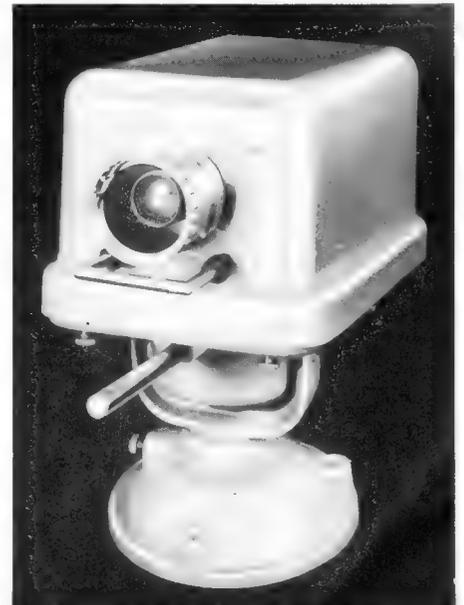
Rechts: Bild 2. Kamerakopf d. Siemens-Industrie-Fernsehanlage
