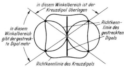
Bild 7. Vergleich zwischen Kreuzdipol und gestrecktem Dipol
