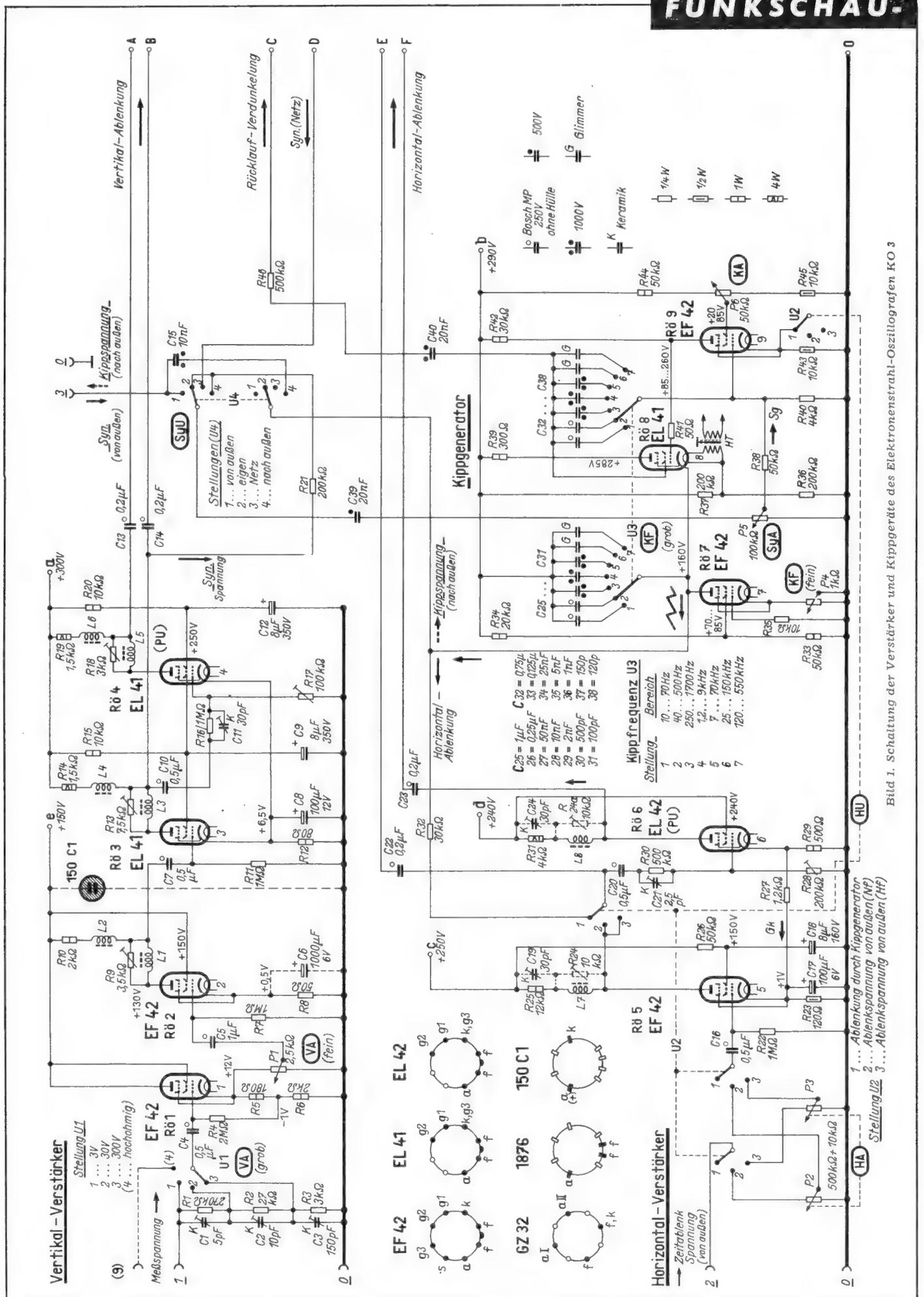
Bild 1. Schaltung der Verstärker und Kippgeräte des Elektronenstrahl-Oszillografen KO 3
