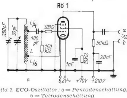
Bild 1. ECO-Oszillator; a = Pentodenschaltung, b = Tetrodenschaltung
