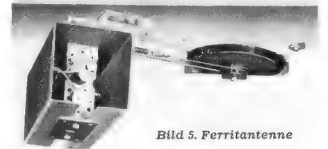
Bild 5. Ferritantenne
