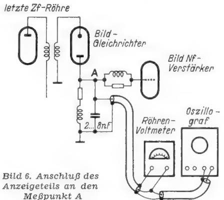
Bild 6. Anschluß des Anzeigeteils an den Meßpunkt A
