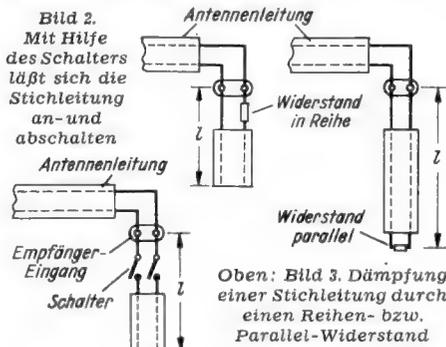
**Bild 2.** Mit Hilfe des Schalters läßt sich die Stichleitung an- und abschalten. Oben: Bild 3. Dämpfung einer Stichleitung durch einen Reihen- bzw. Parallelwiderstand
