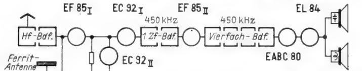
Bild 2. Blockschaltung für KW-, MW- und LW-Empfang
