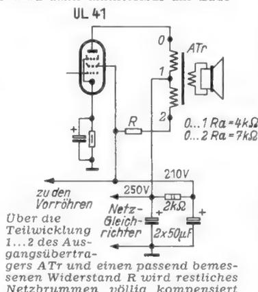
Die Größe von R wird schnell ermittelt, indem man zunächst einen Drehwiderstand von 5 kΩ versuchsweise einsetzt und dessen Schieberring verdreht, bis das Netzbrummen restlos verschwindet. Der eingestellte Widerstandswert wird gemessen und durch einen Festwiderstand ersetzt. Im Versuchsgerät war ein Vorwiderstand von 3 kΩ erforderlich.
