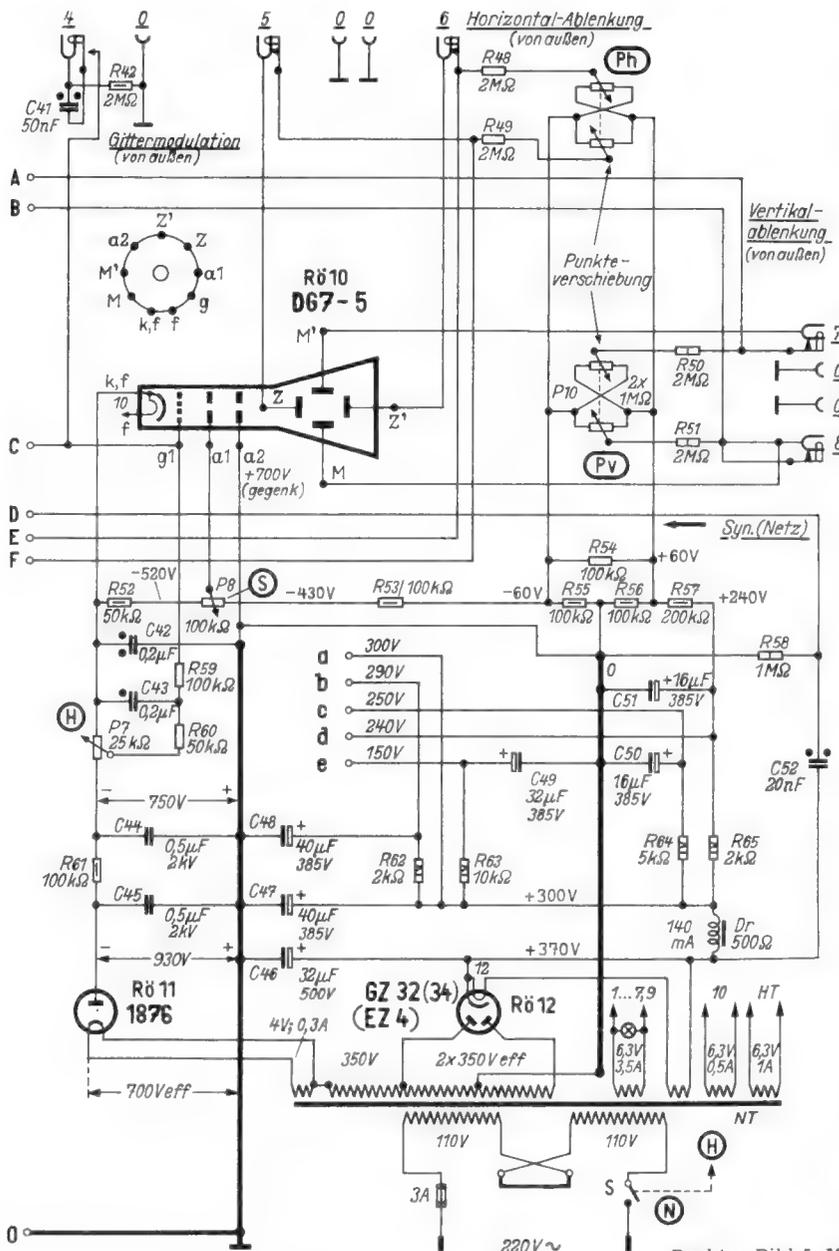
Bild 2. Schaltung von Anzeige- und Netzteil
