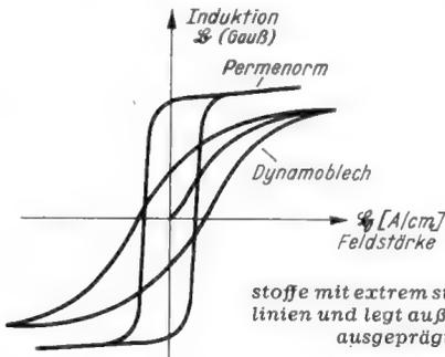
**Bild 4.** Schematischer Vergleich der Hysteresschleifen von gewöhnlichem Dynamoblech und Permenorm 5000 Z. Die Steilheit der Schleifen ( $B/H = \mu$ ) ist ein Maß für die Permeabilität. Für magnetische Verstärker, besonders solche kleiner Leistung, benötigt man hochpermeable Werkstoffe mit extrem steilen Magnetisierungskennlinien und legt außerdem Wert auf einen scharf ausgeprägten Sättigungsknick
