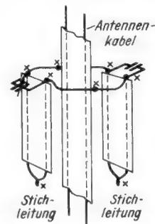
**Bild 4.** Aufbau einer abstimmbaren Stichleitung. Die Kreuze bezeichnen die Lötstellen. Alle Teile sind der Deutlichkeit halber weit auseinandergezogen gezeichnet. In der praktischen Ausführung müssen Stichleitung und Antennenkabel eng gepackt aufeinander liegen
