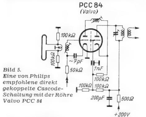
Bild 5. Eine von Philips empfohlene direkt gekoppelte Cascode-Schaltung mit der Röhre Valvo PCC 84
