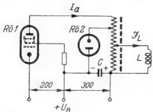
Bild 137. Zeilenend-röhre mit Ausgangsüber-trager und Schalter-bzw. Spardiode
