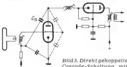
Bild 3. Direkt gekoppelte Cascode-Schaltung mit kapazitiver Neutralisation
