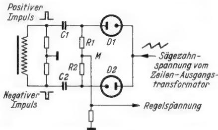
Bild 130. Brückenschaltung mit zwei Dioden zur Phasensynchronisierung
