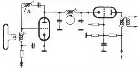
Bild 2. Direkt gekoppelte Cascode-Schaltung mit induktiver Neutralisation
