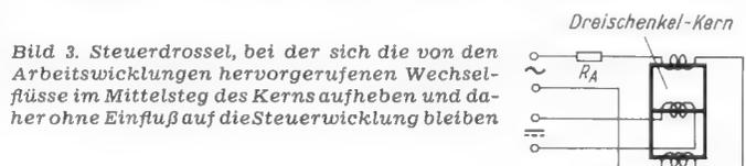
Bild 3. Steuerdrossel, bei der sich die von den Arbeitswicklungen hervorgerufenen Wechselströme im Mittelsteg des Kerns aufheben und daher ohne Einfluß auf die Steuerwicklung bleiben
