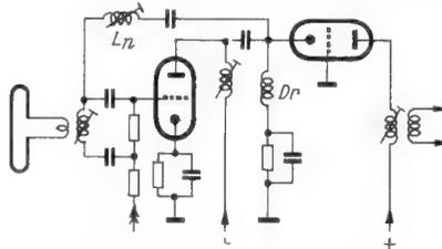
Bild 1. Kapazitiv gekoppelte Cascode-Schaltung mit induktiver Neutralisation
