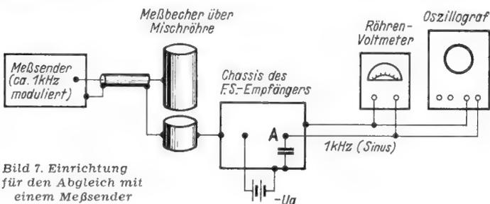
Bild 7. Einrichtung für den Abgleich mit einem Meßsender
