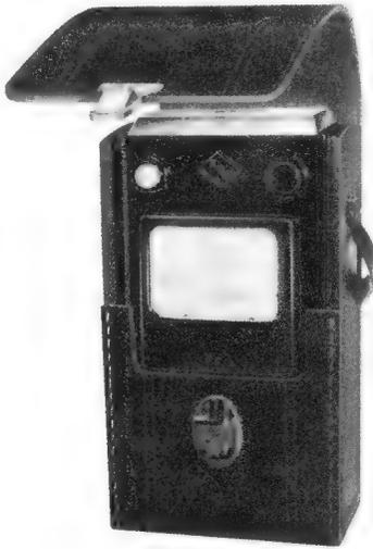
sich am Anzeigeelement ein Ausschlag ergibt, der der Größe und der Polarität der Aufladung entspricht. Zur Stromversorgung dient eine 3-V-Stabbatterie, deren Zustand in einer Eichstellung überwacht wird. Abmessungen: 18,7x9,8x5,8 cm; Gewicht: 0,8 kg. Preis: 250 DM. Hersteller K. P. Mündinger GmbH, Renningen/Württ.
