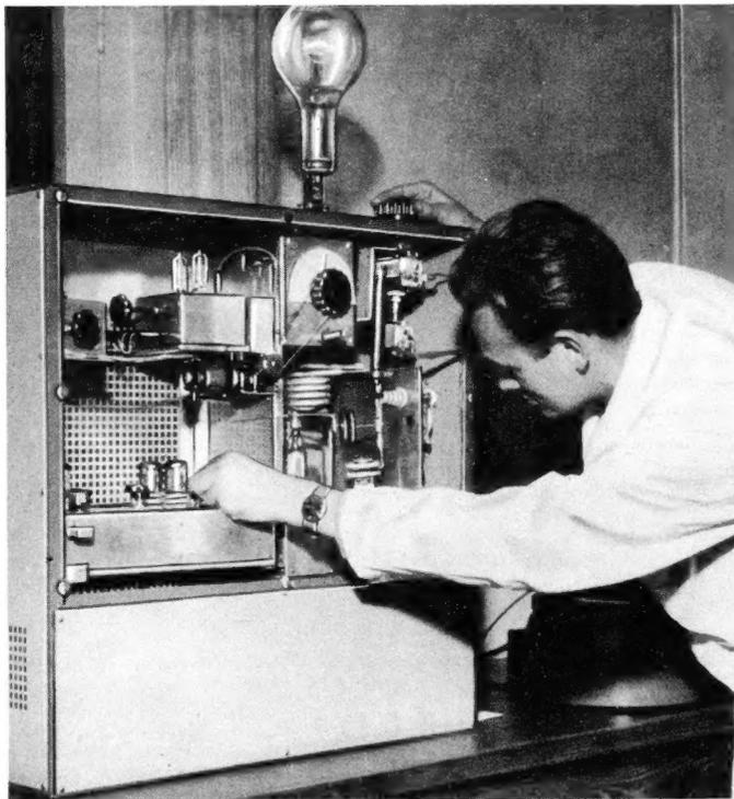
Bild 2. Versuchsaufbau einer automatischen Nachlaufsteuerung im Diathermiegerät
