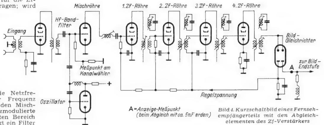
Bild 4. Kurzschaltbild eines Fernsehempfängerteils mit den Abgleichselementen des Zf-Verstärkers
