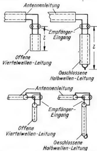
**Bild 1.** Die Stichleitungen werden stets parallel zur Antennenleitung an den Eingang des Empfängers gelegt. Die Länge der Stichleitung  $l$  mißt vom Empfängereingang bis zum letzten Ende der Leiter des Kabelstücks
