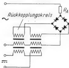
**Bild 5.** Rückgekoppelter magnetischer Verstärker mit besonderen Rückkopplungswicklungen
