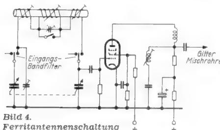
Bild 4. Ferritantennenschaltung
