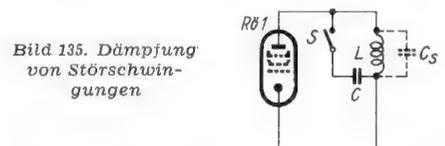
Bild 135. Dämpfung von Störschwingungen
