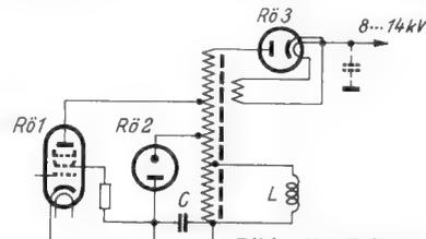
Bild 139. Zeilenendstufe mit Hochspannungsgleichrichter
