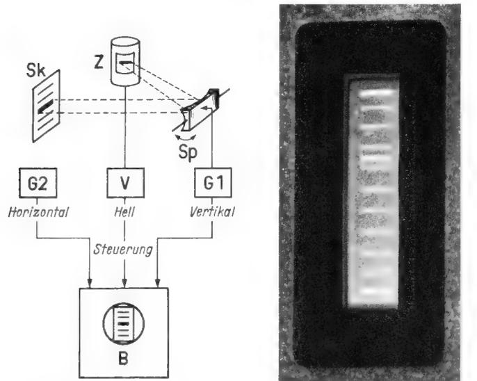
Bild 1. Arbeitsschema des Eloskop-Verfahrens
