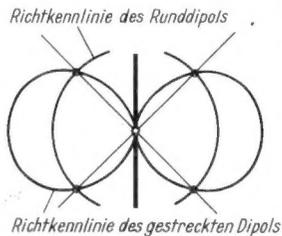
Bild 8. Vergleich zwischen Runddipol und gestrecktem Dipol
