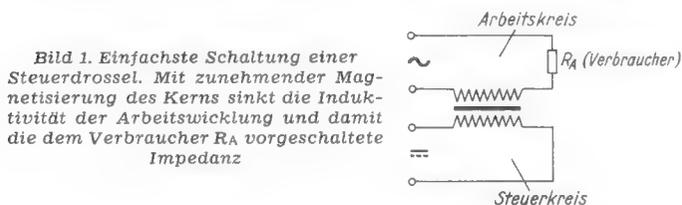
Bild 1. Einfachste Schaltung einer Steuerdrossel. Mit zunehmender Magnetisierung des Kerns sinkt die Induktivität der Arbeitswicklung und damit die dem Verbraucher  $R_A$  vorgeschaltete Impedanz
