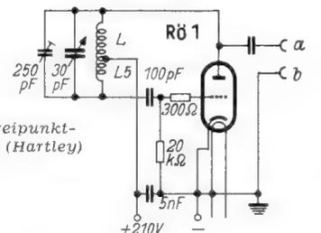
Bild 5. Dreipunkt-Oszillator (Hartley)
