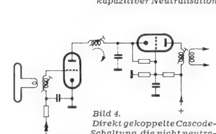
Bild 4. Direkt gekoppelte Cascode-Schaltung, die nicht neutralisiert zu werden braucht (s. Text)
